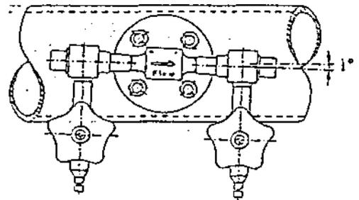
Рис. 7 Установка в горизонтальной трубе
