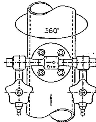
Рис. 3 б. Установка в вертикальной трубе
