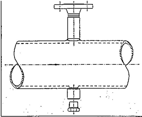
2. После успешного монтажа сварной муфты возьмите шнур и привяжите узлом к концу муфты. Другой конец обведите так вокруг трубы, чтобы по окружности трубы образовалось кольцо. Обозначьте конец половины кольца на трубе.
