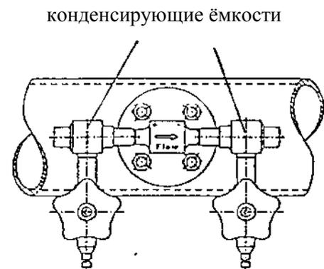
Рис. 4 б. Установка в горизонтальной трубе
