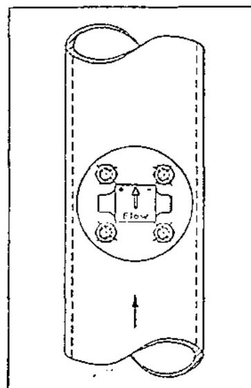
Рис. 2. Положение отборов давления при вертикальном расположении труб
